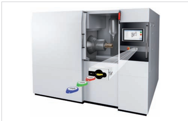
Obr. 2 Euchner EKS FSA a dotykový displej pro bezpečnou volbu provozního režimu
