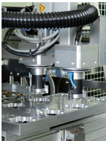
Dva kompaktné otočné moduly Festo ERMO-16 ukladajú zálisky do matrice.
